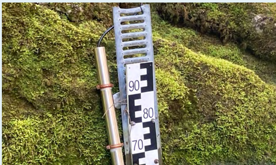
Tube abritant une sonde de mesure et une échelle limnimétrique de contrôle – Photo : Bertrand Joly
