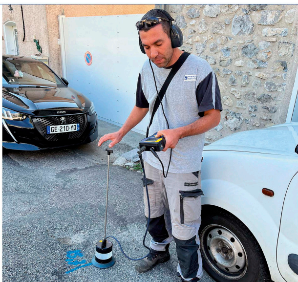
▲ Agent du Grésivaudan à la recherche de fuites.
